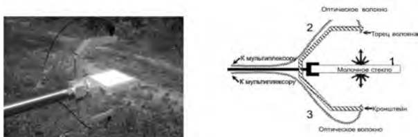
Рисунок 2 – Измерительная головка альбедометра и ее схематическое изображение
